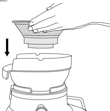
3. Placez le couvercle de l'extracteur sur le bol du panier filtre, en positionnant la partie inférieure du tube d'alimentation au-dessus du panier filtre en acier inoxydable.
